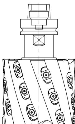
L Fräser kann auch gestürzt montiert im Linkslauf eingesetzt werden
