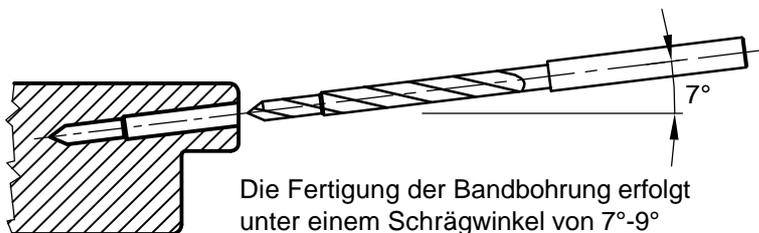
Die Fertigung der Bandbohrung erfolgt unter einem Schrägwinkel von 7°-9°
