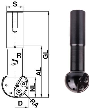
Der C830 ist ein Kugelfräser in Z2 Ausführung und beginnt mit dem Radius 20mm bis 50mm. Ausgeführt ist der C830 mit einem Stahltragkörper und einem Profilmesser mit einer geschliffenen Spanleitstufe. Der Schaftfräser ist bestens für die Erzeugung von segmentförmigen oder halbrunden Relief-Strukturen und zum Abzeilen oder Fertigfräsen von runden oder ovalen Formkörpern oder Konturen geeignet.
